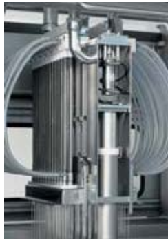
Уникальный игольчатый мост обеспечивает постоянный и качественный уровень иньектирования
