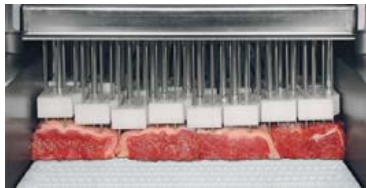
Разделенные на секции пневматические полосы, дополнительно оснащены специальными подошвами, которые удерживают продукт на месте во время иньектирования.
